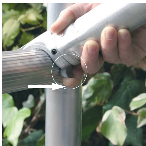
Poprzeczki i poręcze są łatwe w montażu dzięki zaczepom dociskowym. Поперечины и перила простые в монтаже благодаря зажимным крючком.
