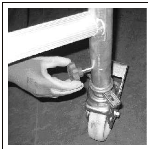
Fot.8: Blokowanie kółek
